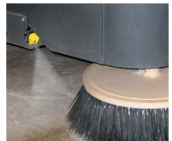
DUSTGUARD™ PORMÉG-KÖTŐ Meggöti a felszálló port az oldalkeféknél
