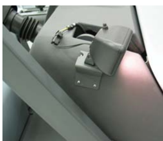
ELSŐ MUNKALÁMPA Az első és hátsó lámpák a normál világítás által nem látható helyekre világítanak
