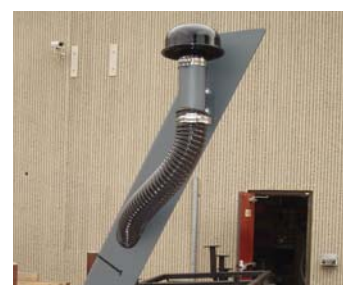
MEGEMELT LEVEGŐ SZŰRŐ A motor által beszívott levegőt a magasból nyerjük. A nehéz ipari körülmények közt alkalmazzuk
